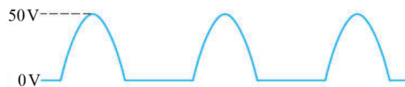
ภาพที่ 1.7 วงจรเรกติไฟเออร์แบบครึ่งคลื่น
