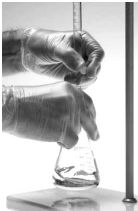
ภาพประกอบที่ 3.1 ตัวอย่างการจับบิวเรตขณะทำการไทเทรต
