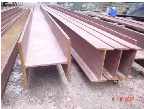
ภาพที่ 6.2 เหล็กรูปพรรณที่ใช้ทำโครงสร้างหลังคา
