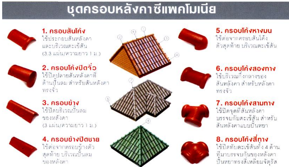
ภาพที่ 6.13 อุปกรณ์ประกอบกระเบื้องหลังคาคอนกรีต ที่มา : แอส ซี จี, บจก.(มหาชน). 2554.
