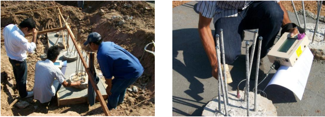
ภาพที่ 2.3 การทดสอบการรับน้ำหนักได้ของเสาเข็มด้วยวิธี seismic integrity test
