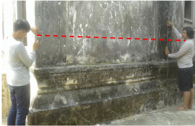
การถ่ายระดับน้ำเพื่อหาแนวเส้นศูนย์สมมุติ (Zero Line) เพื่อการวัด
