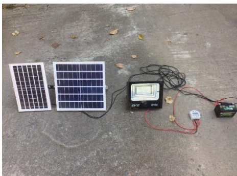
ภาพที่ 8 ระบบเปิด-ปิดไฟอัตโนมัติจากพลังงานเซลล์สุริยะควบคุมด้วยไทม์เมอร์
