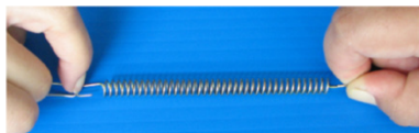
ข. สปริงถูกยืดจนใกล้ขีดจำกัดสภาพยืดหยุ่น
