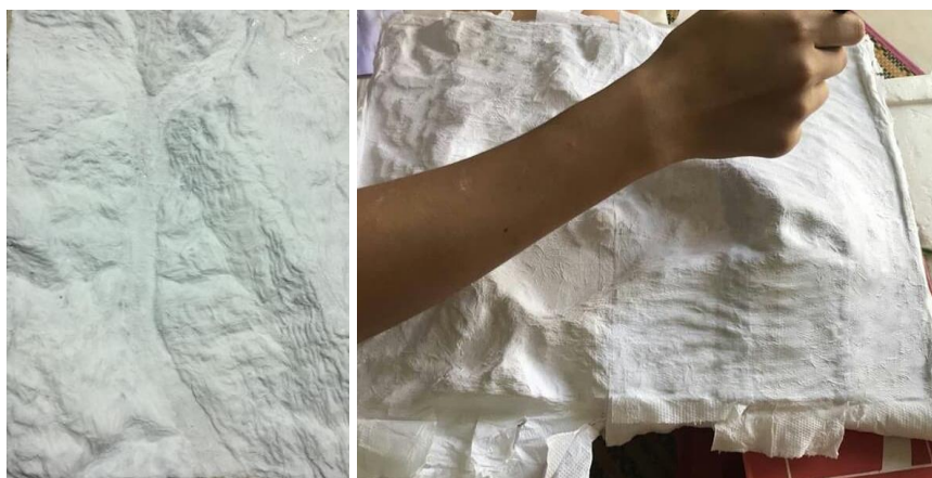
ภาพประกอบ 8.18 การติดกระดาษทึบเพื่อปรับพื้นผิวแผ่นที่ภูมิประเทศเรียบ
