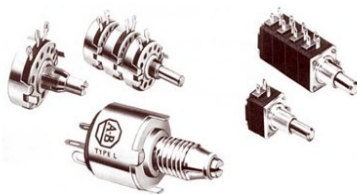
รูปที่ 9 แสดงลักษณะรูปร่างของตัวต้านทานแบบเปลี่ยนค่าได้
