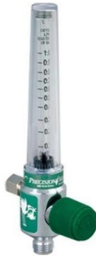
รูปที่ 7.5 อุปกรณ์สำหรับควบคุมอัตราการไหลของออกซิเจน
