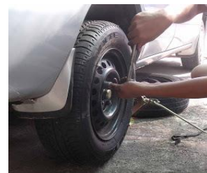
ภาพที่ 7 แสดงตัวอย่างการทำไคเซ็นของการปรับปรุงการขึ้นน็อตล้อรถยนต์
