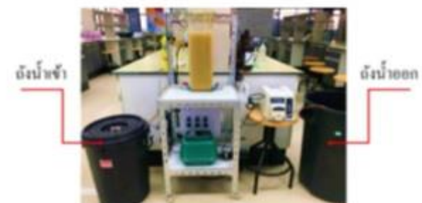
รูปที่ 1 ระบบบำบัดน้ำเสียจำลองแบบ SBR ผลการศึกษาและวิจารณ์ผล
