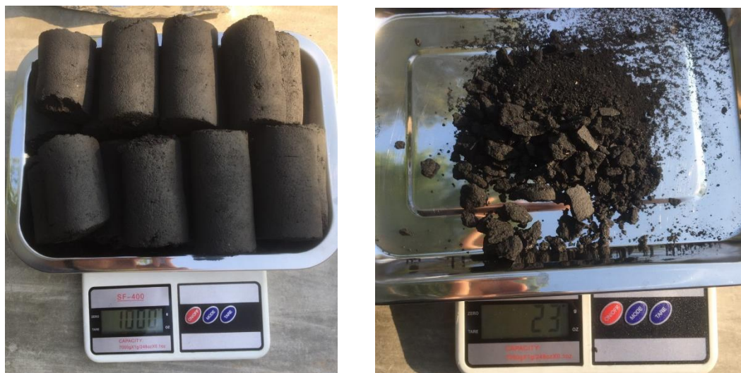
รูปที่ 11 ข นำถ่านที่ได้จากการอบมาทดสอบหาดัชนีการแทรกซ้อน จากการปล่อยตกของถ่าน 1,000 กรัม ในระยะ 2 เมตร
