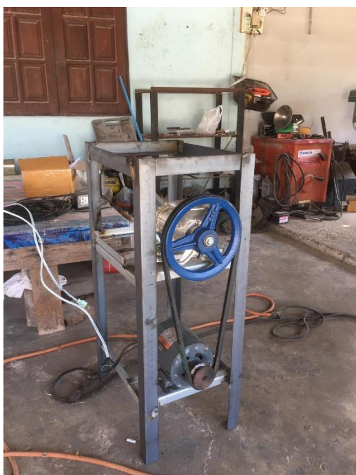
รูปที่ 3 ก ประกอบมู่เล่ย์และมอเตอร์เข้ากับโครงถ่านอัดแท่ง
