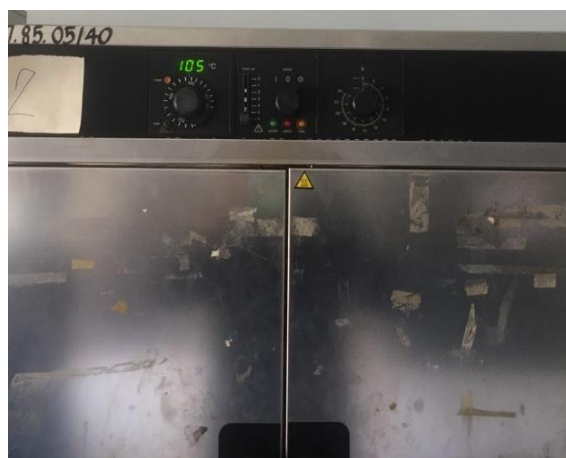
รูปที่ 10 ข นำถ่านที่ตากแล้ว นำไปอบในตู้อุณหภูมิ 105 °C เป็นเวลา 6 ชั่วโมง
