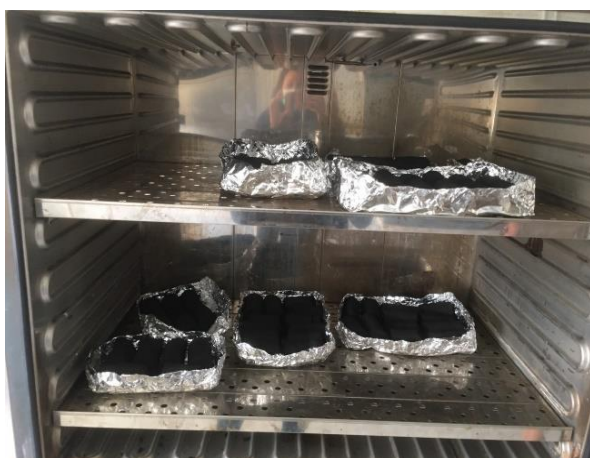
รูปที่ 10 ข นำถ่านที่ตากแล้ว นำไปอบในตู้อุณหภูมิ 105 °C เป็นเวลา 6 ชั่วโมง
