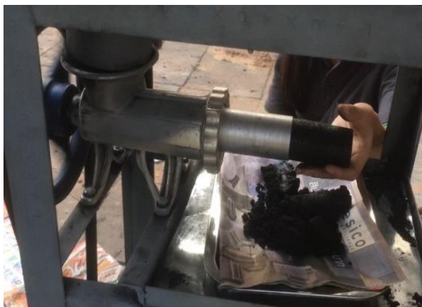
รูปที่ 8 ข ก้อนถ่านที่ได้จากการอัด ตากแดดประมาณ 3 - 5 วัน
