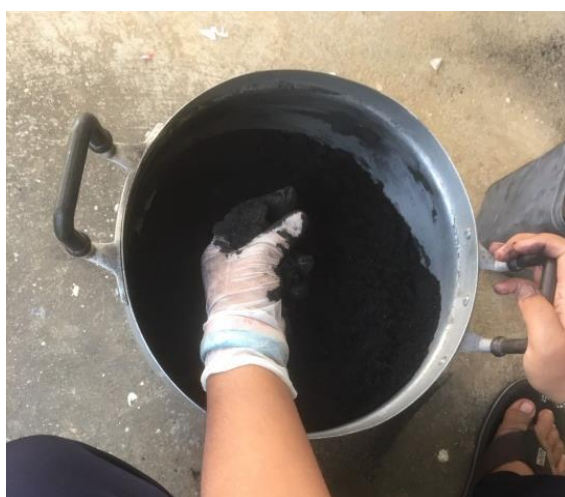
รูปที่ 6 ข เทถ่านบดละเอียดลงไป คนและนวด ให้เข้ากัน ลองบีบแล้วเป็นก้อนแน่นก็ใช้ได้
