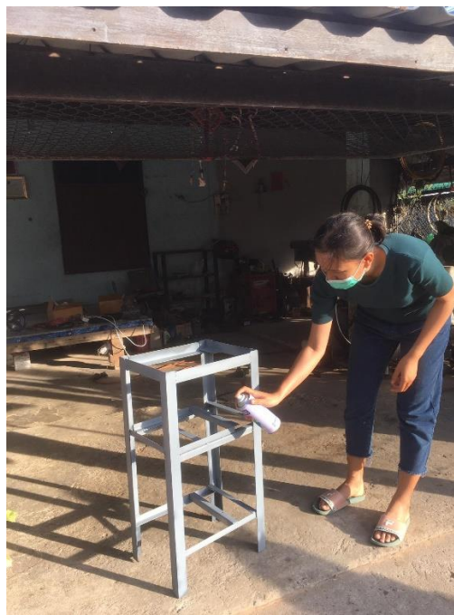
รูปที่ 2 ก ฟันสีโครงถ่านอัดแท่ง
