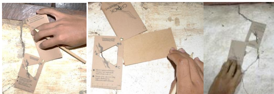
ภาพที่ 8 แสดงการนำการ์ดตรวจสอบการขยายรอยร้าว อุโบสถวัดโพธาราม อ.นางรอง จ.บุรีรัมย์
