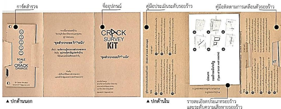
ภาพที่ 1 ตัวปกชุดสำรวจรอยร้าวผนังก่ออิฐ
