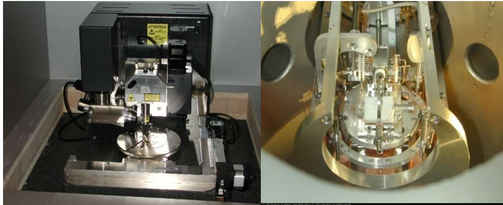
ภาพที่ 2.1 เครื่อง AFM (Atomic force microscope)
