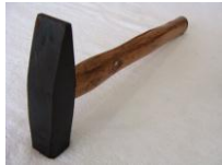
รูปที่ 1 หัวค้อนย้ำหมุดที่ผ่านการชุบผิวแข็ง
