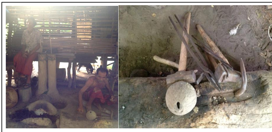
ภาพที่ 5 การตีเหล็กแบบลูกสูบที่ยังคงหลงเหลืออยู่ในชุมชน ของคุณตาเผือก และคุณขายน้อย จินดาศรี ที่มา : ฉวีวรรณ ยอดอินทร์, 2555
